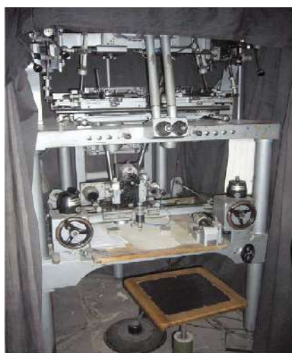
Рис.2 СПР-2 Стереопроектор Романовского (1954г)
